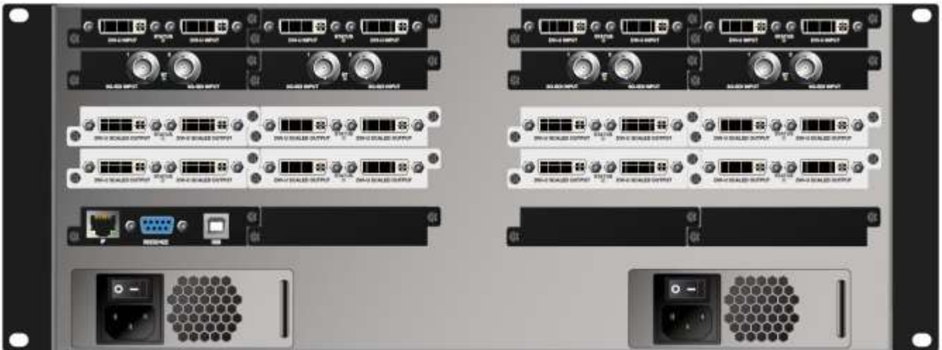
32 HD-SDI input, 32 non-scaling HD-SDI output Configuration
