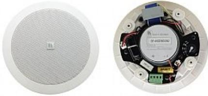
El Galil 4-CO son un par de altavoces de dos vías, 8Ω, recinto acústico abierto, diseñado para instalación en techo. Los altavoces tienen la característica de transformador de potencia con diferentes pasos para selección de 8Ω o ajustes de tensión línea de 70V/100V adecuados para la instalación en cadena
