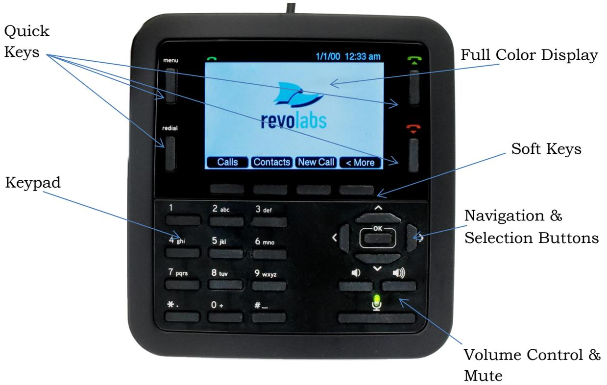
**Figure 2: Keypad Detail**
