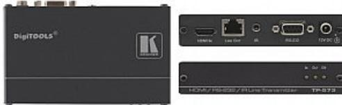
El TP-573 es un transmisor de par trenzado DGKat™ para HDMI, RS-232 bidireccional y señales infrarrojas. El TP - 573 convierte las señales de entrada en una señal de par trenzado y el TP - 574 la vuelve a convertir a HDMI, RS - 232 y señales infrarrojas
