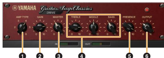
El tipo de amplificación DRIVE proporciona una variedad de sonidos de distorsión que simulan el carácter tonal o varios amplificadores de tubo de alta ganancia. Desde un "crunch" ligeramente sobremodulado hasta una gran distorsión adecuada para estilos hard rock, heavy metal o hardcore, este modelo ofrece una amplia variedad de prestaciones de sonido.
