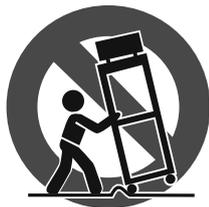
12. Use únicamente la carretilla, plataforma, trípode, soporte o mesa especificados por el fabricante o suministrados junto con el equipo. Al transportar el equipo, tenga cuidado para evitar
